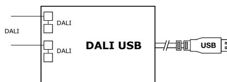
Le module DALI USB assure la liaison entre l'ordinateur et le réseau DALI. L'utilisation du software DALI permet de programmer l'ensemble de l'installation d'éclairage au départ du PC.
