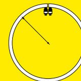
Ces lampes ont les mêmes caractéristiques que les lampes MT5-B5, mais grâce à leurs électrodes perpendiculaires elles peuvent être intégrées facilement dans des plafonds ou parois. Elles conviennent donc parfaitement pour être appliquées en éclairage rasant.
